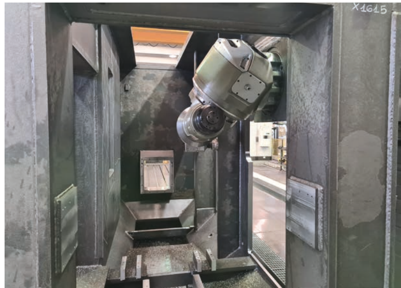
Lavorazione di spianatura su un pezzo molto grande, ossia la struttura di un tornio completo
